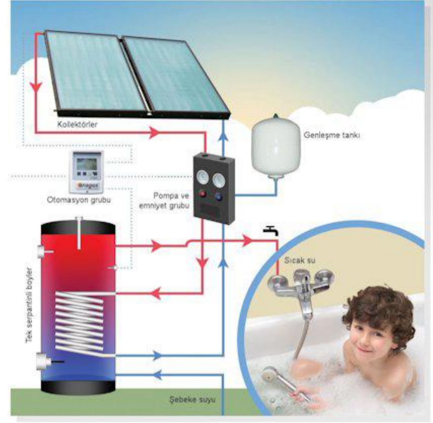
Tek serpantinli boyler ile kullanım şeması (Yalnızca güneş enerjisi kullanımı için)
